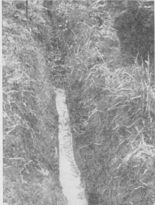
Kuva 12. Sama koe kuin kuvassa 11. Noin 90 m:n päässä, ojan alapäässä tulee sepelikerroksesta leveä vesivirta.
