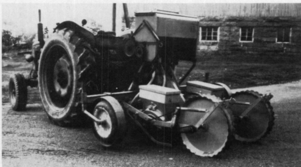
Kuva 1. Maissin kylvökone Kleine Maxicorn, johon on asennettu Vakolassa suunniteltu lannoitusyksikkö. Lannoitusyksikkö sijoittaa lannoitteen kylvörivin molemmiin puolin.
