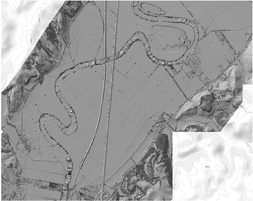
Fig. 4. A digital terrain model (DTM) of the Marcigliana area based on LiDAR data (resolution 1 x 1 m). Note the modern gravel/sand extraction pits. Map data: Ministero dell'Ambiente e della Tutela del Territorio e del Mare.
