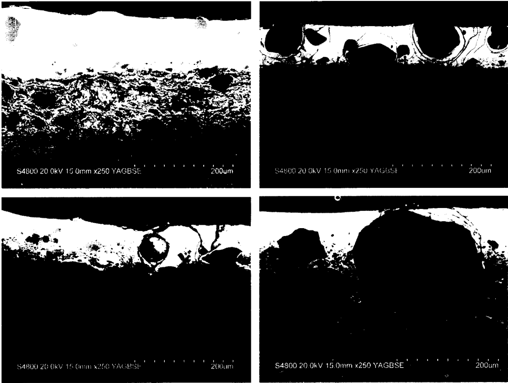
Kuva 5. SEM-BSE-mikroskooppikuvia punasavikeramiikan seinämän poikkileikkauksista, joissa näkyy astian seinämän kerroksisuus: lyijyrikaslasitekerros (kirkas kerros kuvien yläosissa), rautapitoisen liete kerros (slip) ja keramiikka-aines sekoitteen. Vas. ylh.: Näyte V4 (Gubbacka-ryhmä 2a); vas. alh.: V15 (Mankby, ryhmä 2b); oik. ylh.: V6 (Gubbackasta, tuontiryhmä 1a); ja oik. alh.: V17 (Tallinna, tuontiryhmä 1b). Nk. kotimaisen ryhmän (2) paloissa näkyy lasitteiden epätasaisuus ja tuontiryhmän (1) astioissa lasitteen pintaa rikkova runsas hiekkasekoitteen käyttö.
