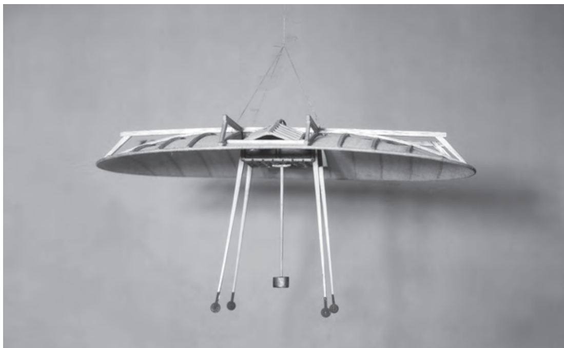
Miniatyrmodell av Swedenborgs flygmaskin. Den påminde om en fyrbent insekt och hade mycket gemensamt med grundprinciperna för de moderna flygplanen. Bild: Tekniska Museet, Stockholm.
