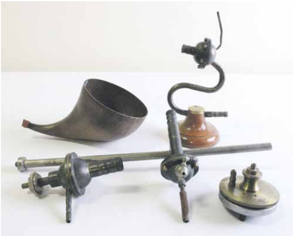
Kuva 2. Eric Tigerstedtin kaasuliekkimodulaattori. Lähde: Tekniikan museo, Eric Tigerstedt -kokoelma.
