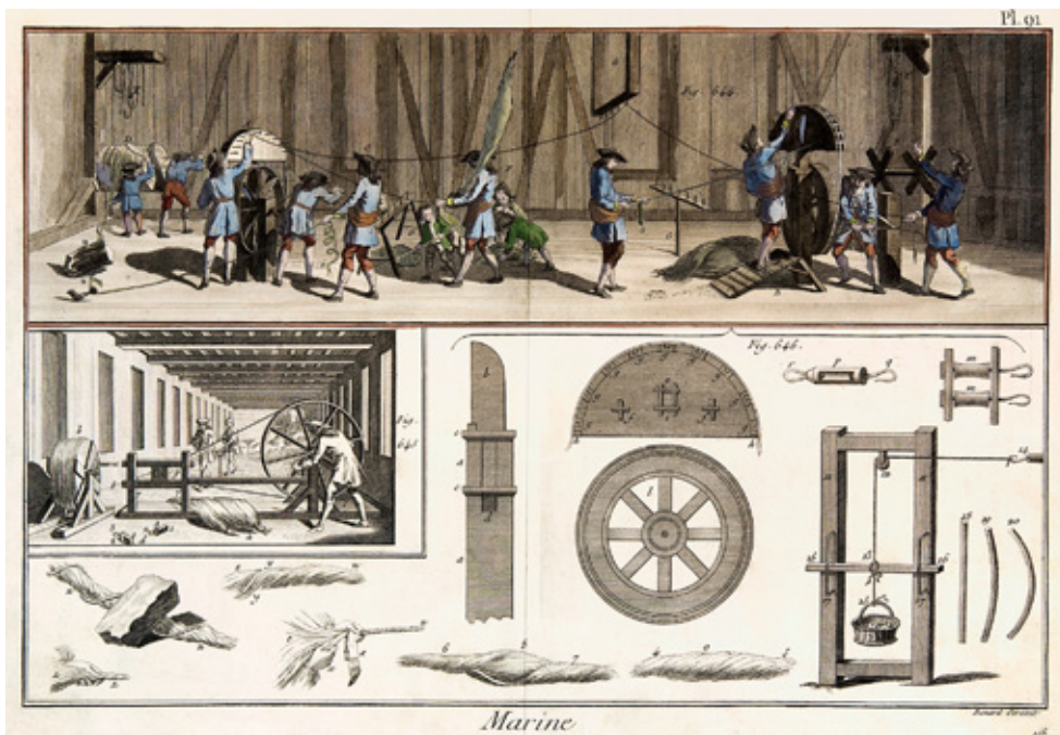
Köydenpunontarata ja sen välineistöä Diderot'n Ensyklopediassa. Köysiä tehtiin kotimaisesta ja venäläisestä hampusta, minkä lisäksi sitä saatiin haaksirikkoaluksista. Silti se oli huuto-kaupoissa erittäin arvokasta. Lapsityövoima oli tärkeä osa köysituotantoa. Kuva: Mikko Huhtamiehen kokoelmat.
