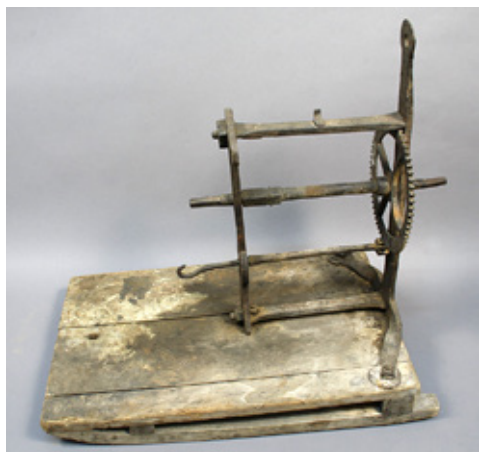
Köydenpunontalaite. Rautainen köydenkiertämiskone puisella kelkkamaisella alustalla. Koneessa on iso hammasratas, joka pyörittää alapuolella varren päässä olevaa koukkuja, johon hamppu- tai muut säikeet on kiinnitetty kiertämistä varten. Hammasratas pyörityskampi puuttuu, samoin kuin toinen ja kolmas koukku (jos sellaisia on ollut). Kuva: Suomen merimuseon kokoelmat.
