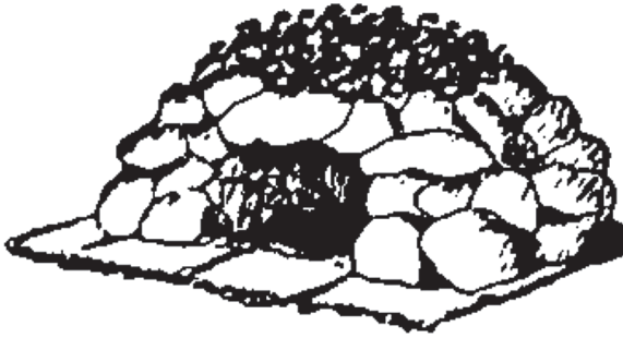
Kuva 1. Alkukantaiselle savupirtille ja saunalle ominainen avo- eli rauniokiuas Helamaan (1999, 119) mukaan.
