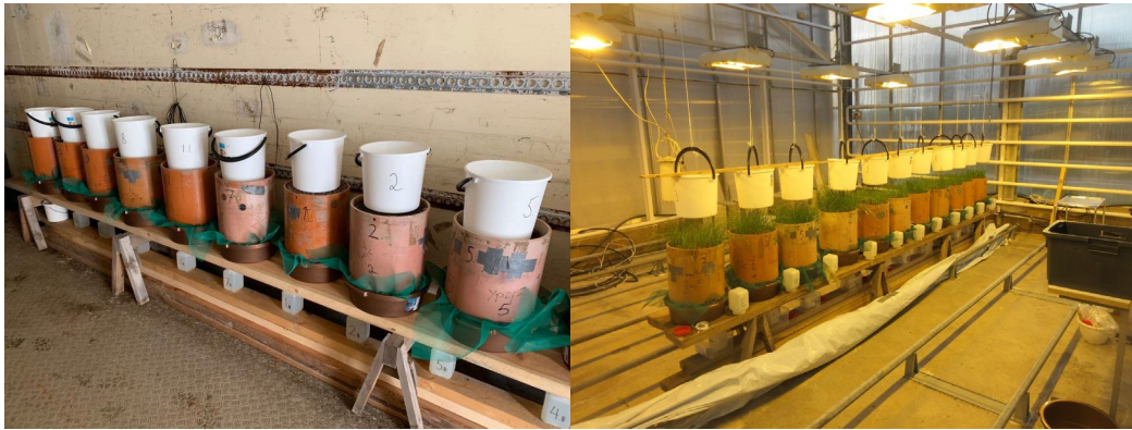
Kuva 2. Maamonoliittikoejärjestely syys- ja kevät simulaatioiden aikana (vasen) ja kesäsimulaation aikana (oikea)
