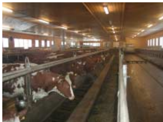
Kuva 2. Ketjuruokintapöytä säästää kallista lattia-pinta-alaa uuteen pihattoon asennettuna. Täyttöjärjestelmän avulla jopa täysautomatisointi onnistuu. Hankinta- ja asennushinta on alhainen. Ryhmäkohtainen ruokinta on mahdollista.
