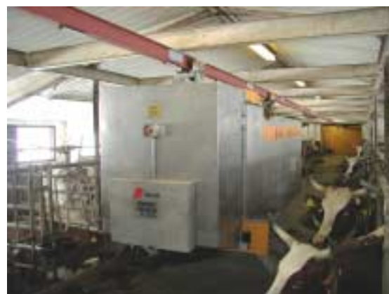
Kuva 4. Kiskoruokkija voi jakaa myös väkirehut yksilöllisesti. Ruokinnan optimointitaso on korkea ja ruokinnan hygieniariski on pieni. Laite sopii kapeahkollekin käytävälle. Hankinta- ja asennuskustannukset ovat korkeat: n. 25 - 35 000 €
