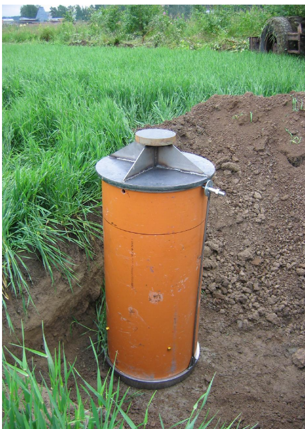
Kuva 3. Suuret maanäytelieriöt sahattiin maaviemäriputkesta ja niiden maahan upottamista varten teetettiin teräsestä leikkausterä ja teräskansi alaspäin suuntautuvan paineen jakamiseksi lieriön reunoille (Kuva A.Simojoki 2007).
