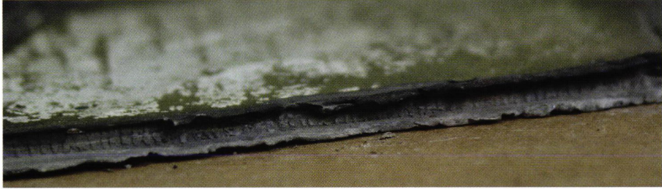
Kuva 11. Lyijypuite, jossa näkyy sekä hammastus että X-kirjain. Kuva Elisa Heikkilä, MV/RHO 2003.
