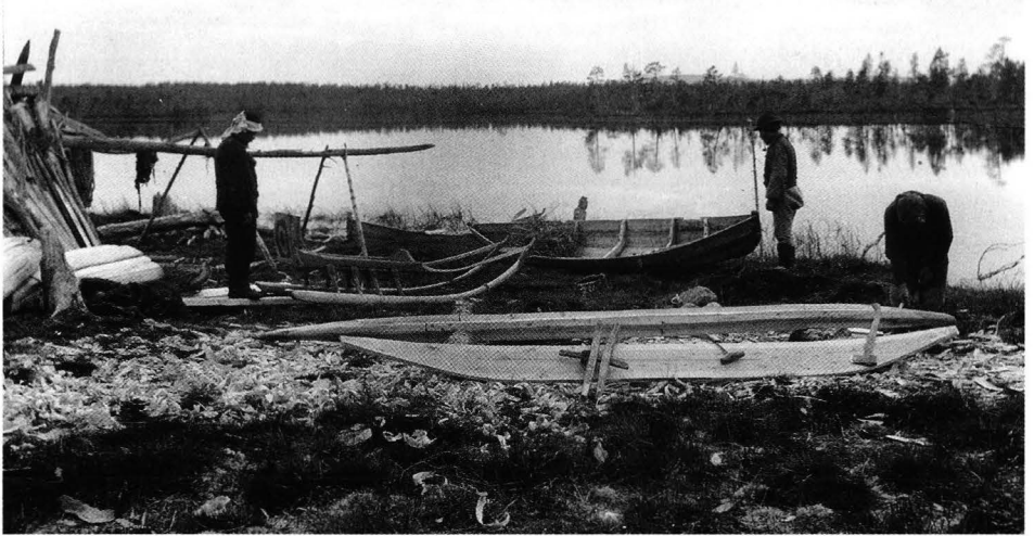
Kuva 2. Ensimmäisellä Petsamon matkallaan vuonna 1912 T. I. Itkonen kuvasi kolttasaamelaisen veneen rakennuksen vaiheita Nevvashjaurin rannalla. Rannan puolella näkyy ompelemalla tehty ns. nuoravene, jonka Itkonen osti kokoelmiin. Vene on luetteloitu numerolla SU 4904:191. Museovirasto / Kansatieteen kuva-arkisto, SUK 117:63.
