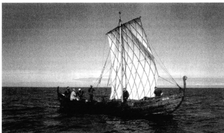
Kuva 14. Lapurin laivasta rakennettiin Raippaluodossa kuvassa oleva replika, joka valmistui 1993. Sen haaksirikkouduttua 1994 rakennettiin uusi. Fredrik Koivusalon ( Rus projektet , 1996) mukaan.
