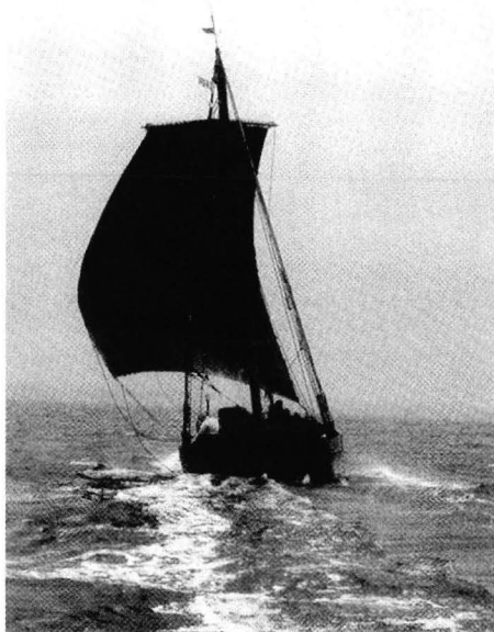
Kuva 12. Skuldelevistä löydetystä viikinkien rahti- aluksesta knarr -ista on valmistettu kuvassa oleva tarkka kopio eli replika, joka osoittautui hyväksi purjehtijaksi. Se on 16 metrin pituinen ja 24 tonnin vetoinen ja 6 hengen miehistön alus, jolla voitiin kuljettaa hevosiakin. Stig Sundbergin (1997) mu- kaan.
