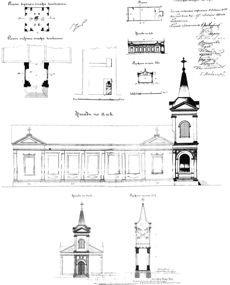
Kuva 9. Hämeenlinnan kaupungissa olevan rakennuksen n:o 42 (kirkon) korjauspiirustus. Helsinki 15. 10. 1879. F. N:o 349, op. N:o 39, ed. hr. N:o 33, 11. VSHKA. Kysymys on kellotornin rakentamisesta vanhan puukirkon (kuva 8) länsipäättyyn. Piirustuksessa oikealla ylhäällä esitellään kirkon olemassaoleva muoto. Fasadikuvien keskellä ja alhaalla vasemmalla osoitetaan, miten uusi umpinainen kellotorni vaikuttaa kirkon ulkonäköön. Tornista tulee selvästi itse kirkkorakennusta korkeampi, niin että se muuttaa laajemminkin kaupunkikuvaa. Ylhäällä keskellä on kirkon sijoituspiirustus, ylhäällä vasemmalla horisontaalipiirustus sekä lattiatasolta että tornin yläosasta. Jälkimmäisestä näkyy kellojen lukumäärä, koko ja sijoittelu. Alhaalla oikealla on tornin leikkaus.
