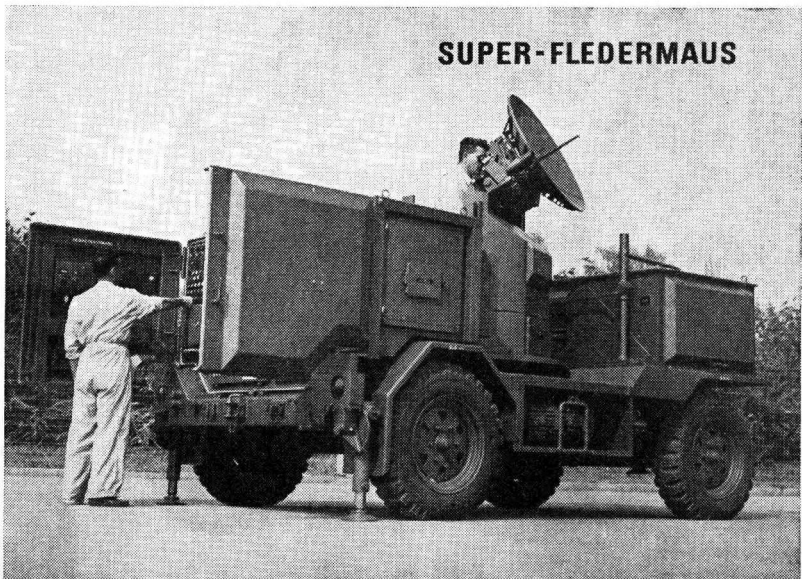
Kuva 4 Automaattijaoksen tutka-keskuslaskin Super-Fledermaus (Sveitsi). Kokonaiskuva
