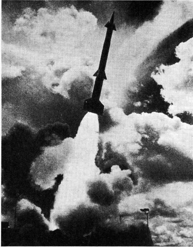
Kuva 19 Amerikkalainen ballististen ohjusten torjuntaohjus Nike Zeus. Suurin torjuntakorkeus 200 km, ydintaistelukärki.
