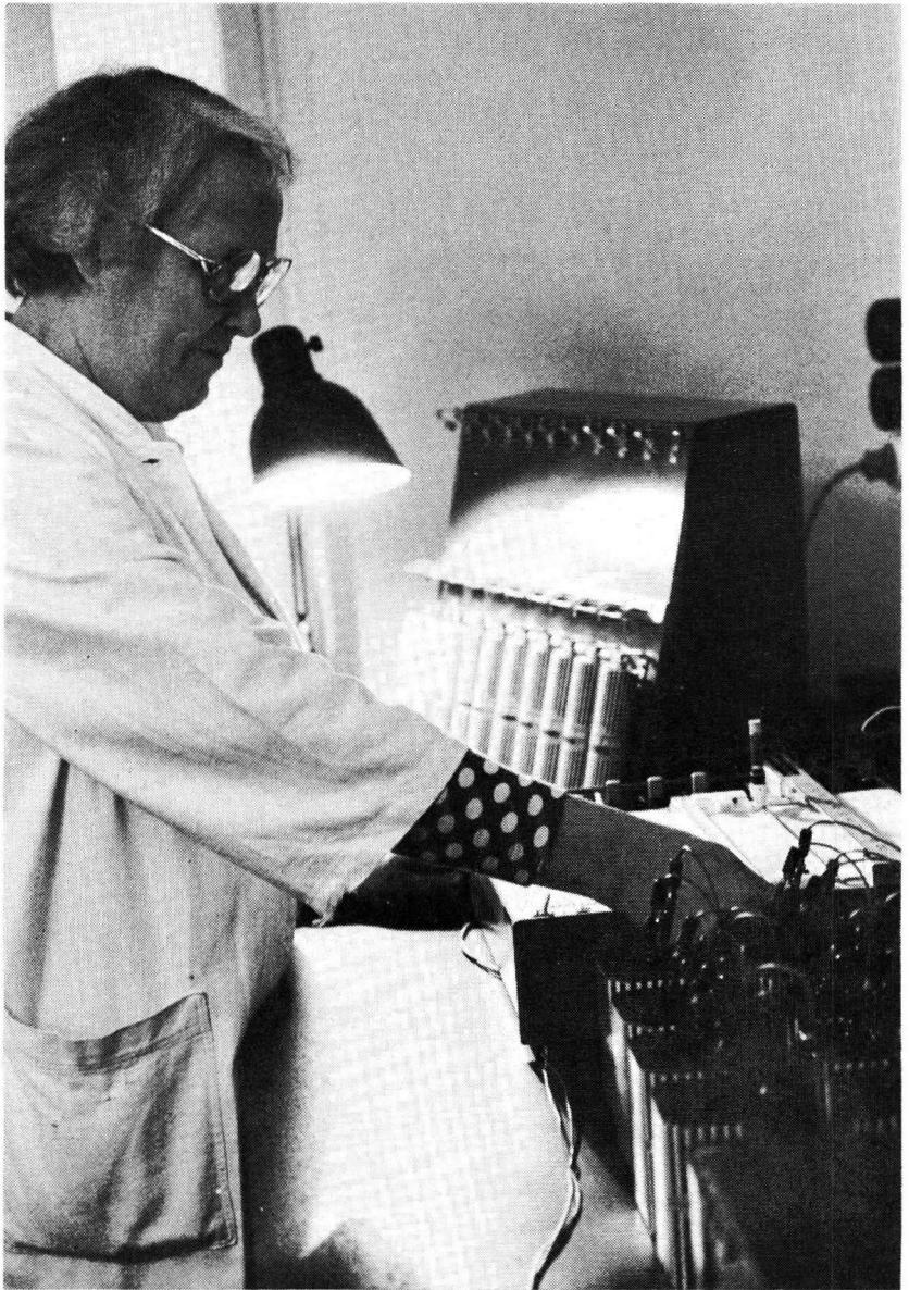
Kuva 8: Paristojen varastointiin liittyvä kuormituskoe käynnissä.
