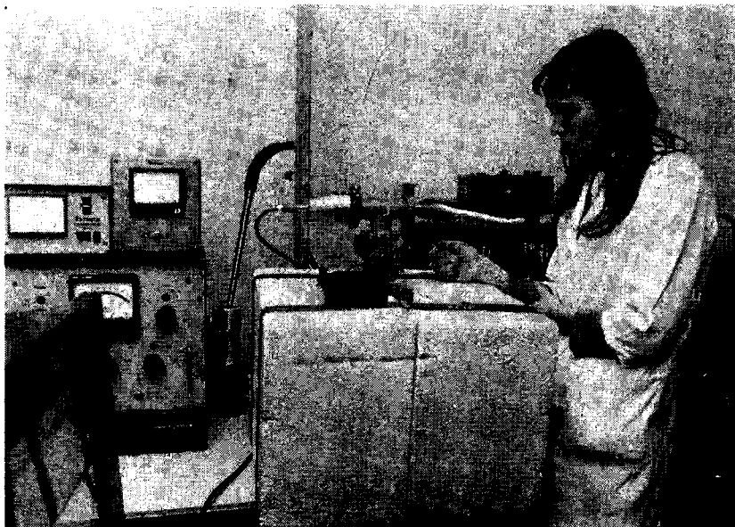
Kuva 7 b: Vakuuimikrovaaka, herkkyys 10^{-6} g.
