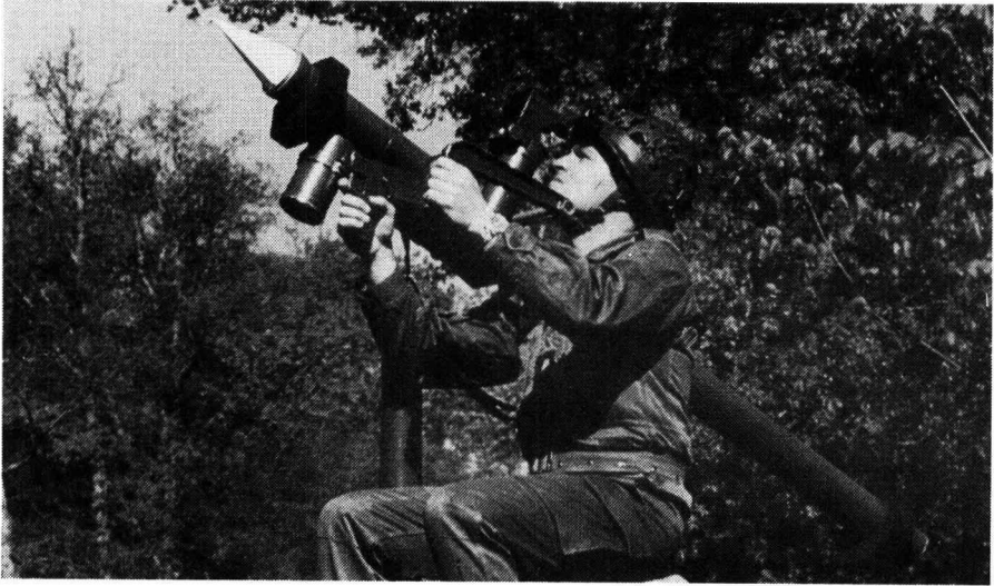
Kuva 6: MISTRAL — infrapunahakuinen lähitorjuntaohjus, jolla voidaan tulittaa myös läheneviä maaleja.
