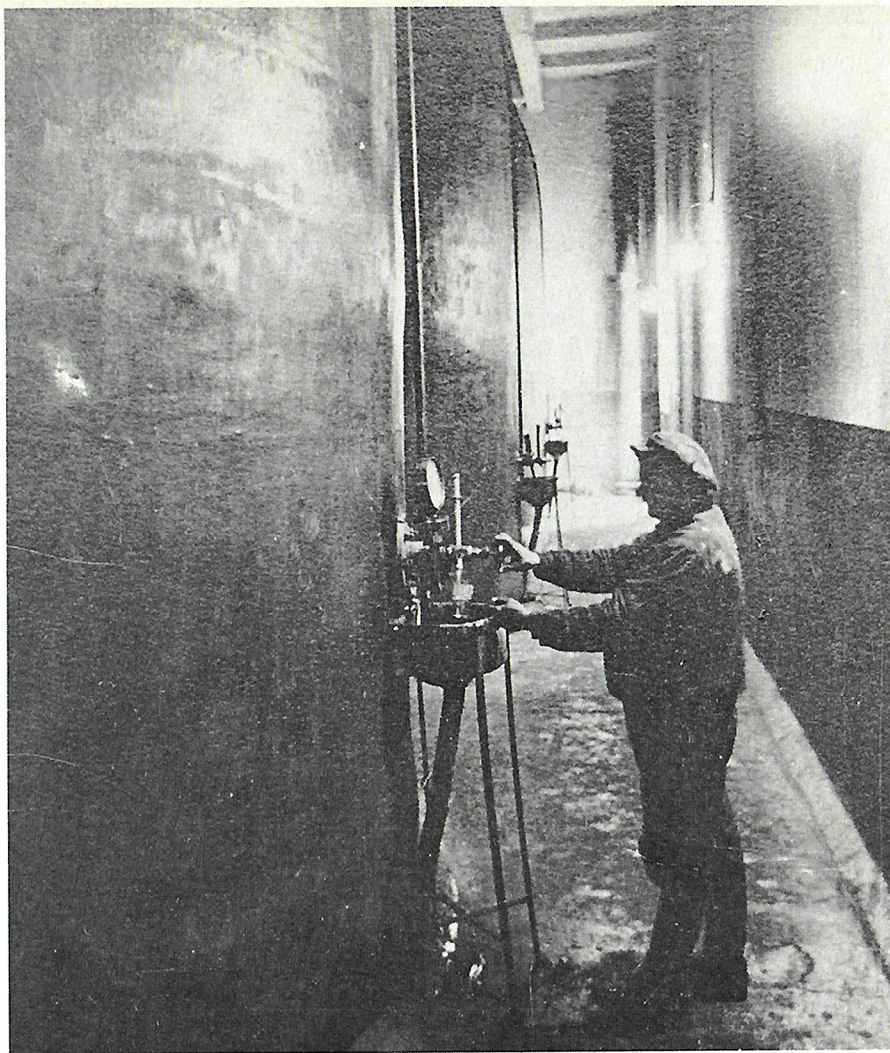
Jämsänkosken keittinosasto. Sellun valmistus vaatii jatkuvaa valvontaa. Mas- san kypsymistä seurattiin keittimen pohjassa olevien näyttöluukkujen kautta.
