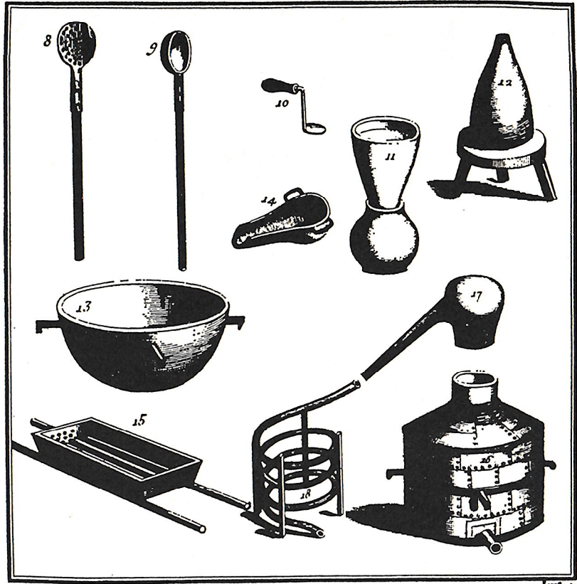
1700-luvun sokerinpuhdistamon työvälineistöä. Kuvassa oikealla alhaalla paloviinan tisluslaite. Kekosokerimuoteista valutettu siirappi pantiin käymään ja tislattiin melassi-paloviinaksi, rommiksi. Maamme ensimmäisessä sokeritehtaassa Turussa oli tietävästi kuvan esittämän tapainen tisluslaite.
