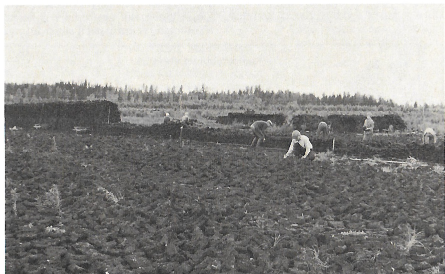
1960-luvulle saakka turvepaloja kuivattiin ristikoimalla tai kekoamalla. Tämä työvaihe samoin kuin turpeiden varastoamaus tehtiin käsityönä.
