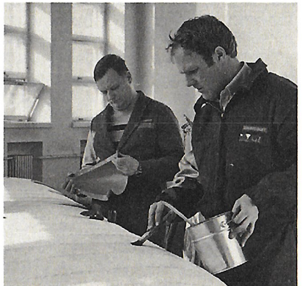
Siiven kiristyslakkaus meneillään (sotmest S. Uolamo ja takana tark E. Rekola). Lakkaus suoritetaan useaan kertaan, minkä jälkeen siihen voidaan maalata väri.
