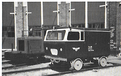
Kevyttä kiskoliikennekalustoa Toijalan vanhan veturitallin edustalla kesällä 1990: edessä Teijon Tehtaiden vuonna 1955 valmistama moottoriresiina TreR:o36, taempana Pedershaab-moottoriveturi. Kuva: Veturimuseo.
