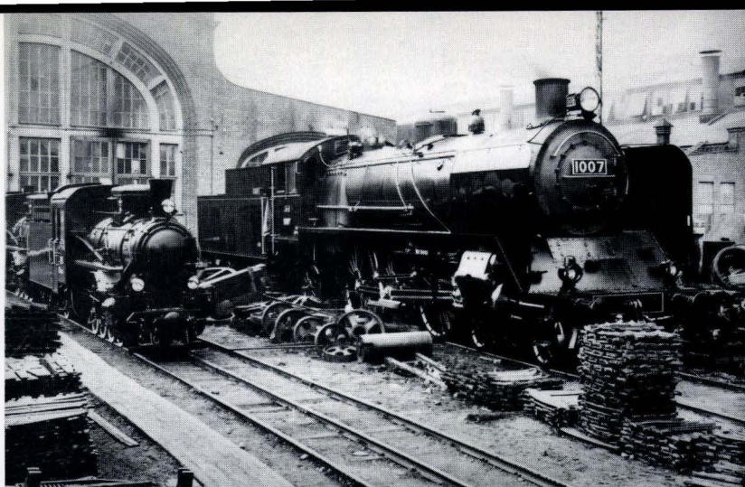
Vielä 1940-luvun lopussa Suomen veturiteollisuus keskittyi lähes yksinomaan höyryvetureihin. Kuva on tamperelaiselta Lokomo Oy:n tehtaalta vuodelta 1948. Vasemmalla on sotakorvauksena Neuvostoliittoon vietäväksi tarkoitettu kapearaiteinen (750 mm) PT-4 -tyyppinen höyryveturi. Oikealla on Valtionrautateille toimitettava Hr1-sarjan raskas henkilöjunaveturi eli Ukko-Pekka nro 1007. Kuva: Veturimuseo.
