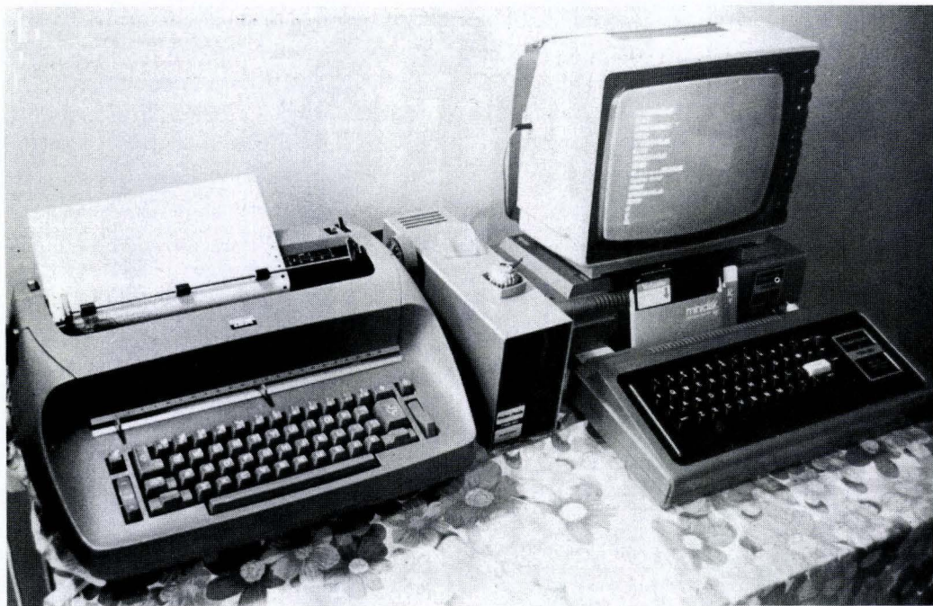
Telmac-kerholaisen aikaansaannoksia. Kuvassa IBM:n sähkökirjoituskone on muutettu mikrotietokoneeseen liitetyksi tehokirjoittimeksi. Kuva on alunperin julkaistu Proessori -lehdessä 2/1979. Kuvaaja: Vesa Valtonen.
