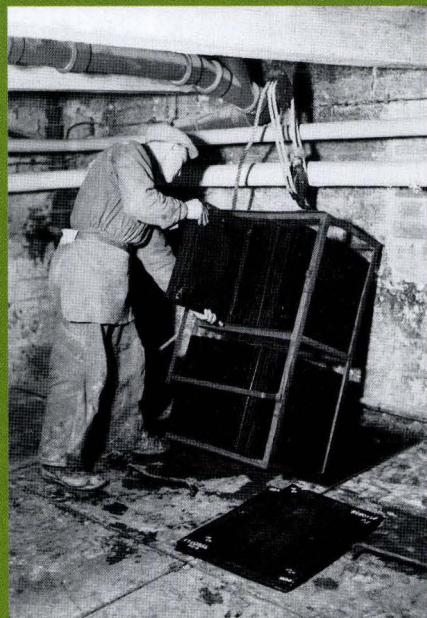
Raaka-ainepalat muokattiin levyiksi hydraulisisissa puristimissa erityisten teräslevyjen välissä (äärimmäisenä vasemmalla). Puristetut kaseiinilevyt koivetettiin luumaisiksi formaliiniliuosaltaisa. Levyjen paksuus määräsi liotusajan (vasemmalla). Kuvat: V. O. Kanninen, 1930-luku, Tampereen museot.
