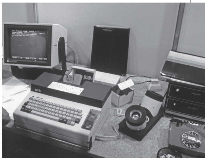
Autologicin liikutettava reporteripäite kuvattuna vuoden 1982 Drupa-messuilla. Puhelimen luuria varten on muotoiltu akustinen modeemi, jolla data muunnettiin äänisignaaleiksi. Massamuistina on sanelukoneen kasetti. Monitori on lisälaite. Matkakäytössä näyttönä oli pieni sisäänrakennettu CRT, joka näytettiin peilin avulla käyttäjälle. Kuva: Osmo Palonen.
