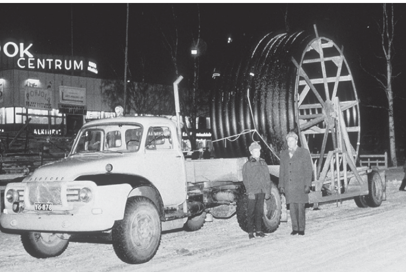
Kelalle kierretty kuuden tuuman muoviputki öisellä matkalla Oulussa vuonna 1961. Kuva: Kalevan arkisto.
