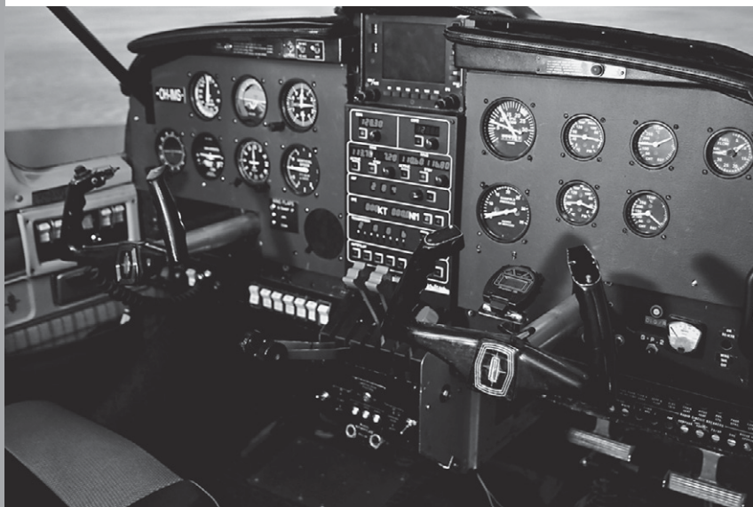
OH-IMS-simulaattori on rakennettu aidon lentokoneen ohjaamoon. Kuva: Juha Klemettinen.
