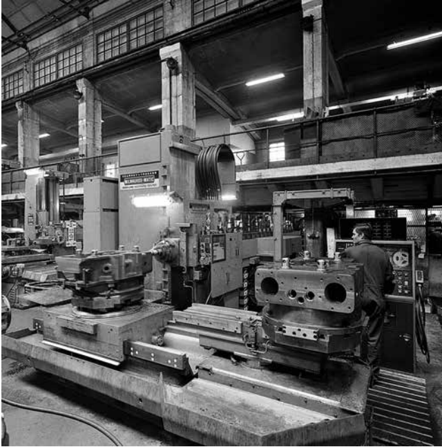
Konepajatyön automaatio eteni 1960–70-lukujen vaihteessa. Kalliit koneinvestoinnit johtivat osaltaan kolmivuorotyön lisääntymiseen. Koneet oli pidettävä tuottavassa työssä. Kuvassa Milwaukee-Matic koneistuskeskus Wärtsilän Turun telakan konepajalla vuonna 1972. Kuva: Wärtsilän Turun telakan kuvaarkisto.
