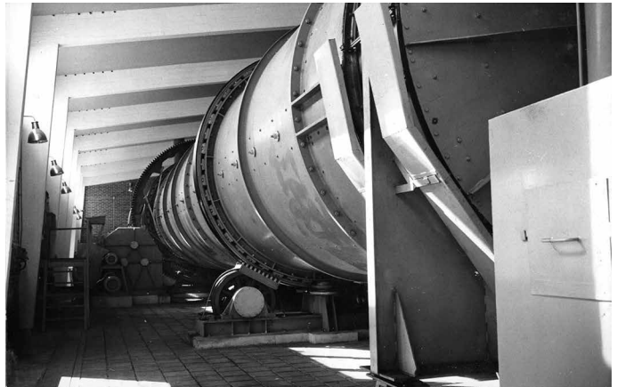
Kuva 3. Turun Dano-biostabi- lisaattorilaitoksen keskeinen laite, hitaasti pyörivä rumpu. Kuva: Lounas-Suomen jätehuolto oy. Turun kaupunginarkisto, Kiinteistö- ja rakennustoimi, Katurakennusosasto, Valokuvat, Ja:2.
