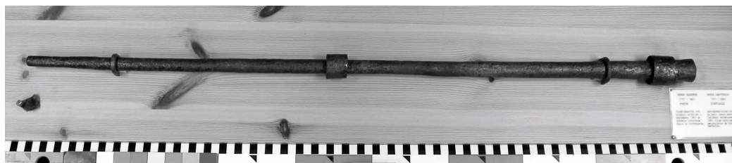
Lasipuhalluspilli ja pala vihreää lasia. Luultavasti irtolöytöjä Bergan lasiruukista, joka toimi Pirttikylässä vuosina 1797–1883 (Hieta 2007). Tehdas tuotti laajan valikoiman lasituotteita, kuten ikkunalasia, pulloja, laseja ja karahveja. Kuva: A. Ahlström Osakeyhtiö.
