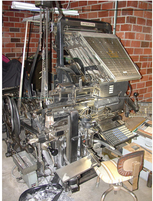
Kuva 6. Intertype-ladontakone. Latojan näppäimellä vastaavat kirjakkeet putoavat riviksi. Väilyöntiä vastaa kiila. Latoja näkee, milloin rivi on tulossa täyteen ja päättää, mihin rivi päätetään (tavuviivaan tai sanan loppuun). Kiiloilla ladelman puristetaan tiukasti leukojen väliin (vrt. myös kuva 8), jonka jälkeen rivistä otetaan kuumametaliladelman. Tämän jälkeen kirjasimet palaavat makasiiniin (ylh.). Latomakoneet varustettiin reikänauhanlukijalla, joka ohjasi konetta (ei ole kuvassa). Näppäimistöä ei silloin käytetty.
