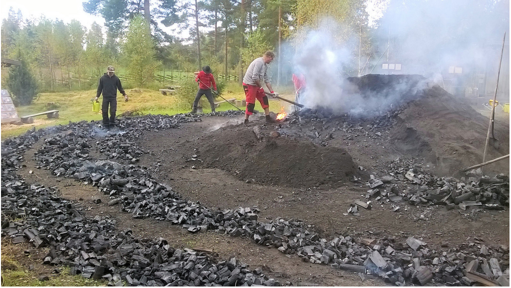
Kuva 2. Pystymiilua puretaan Raaseporin Malmbäckassa vuonna 2016. Karhoihin nostettuja hiiliä jäädytetään tarvittaessa kastelemalla. Kuva: Janne Kangaskesti.
