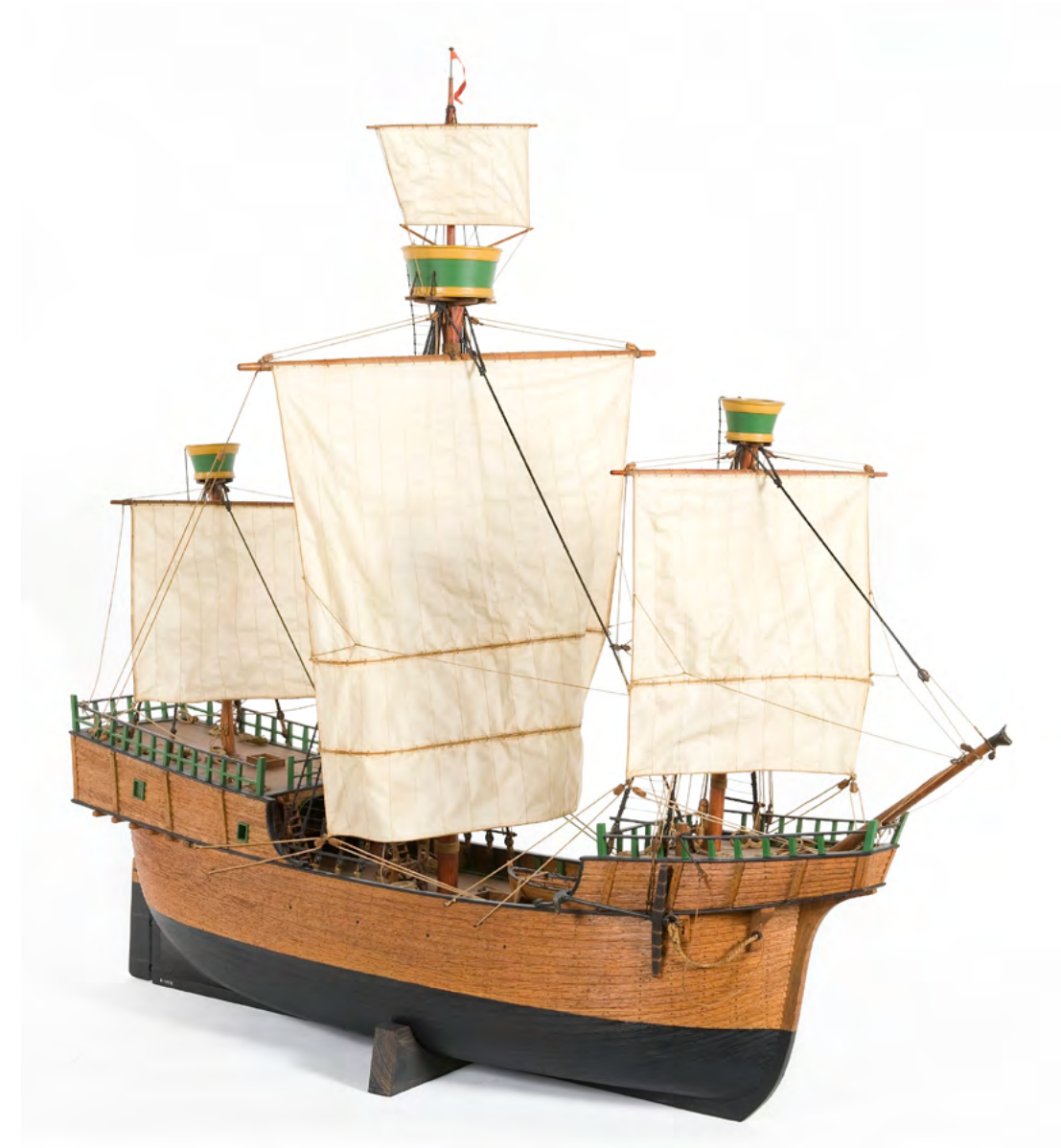
Koggin korvasi 1450-luvulla niin sanottu täystakiloitu alus, jossa oli kolme mastoa ja joka oli yleensä tasakylkinen. Tällä alustyyppillä oli useita nimiä, kuten karakki, kravelli tai holkki, joka oli käytössä Ruotsissa 1550-luvulla asti.
