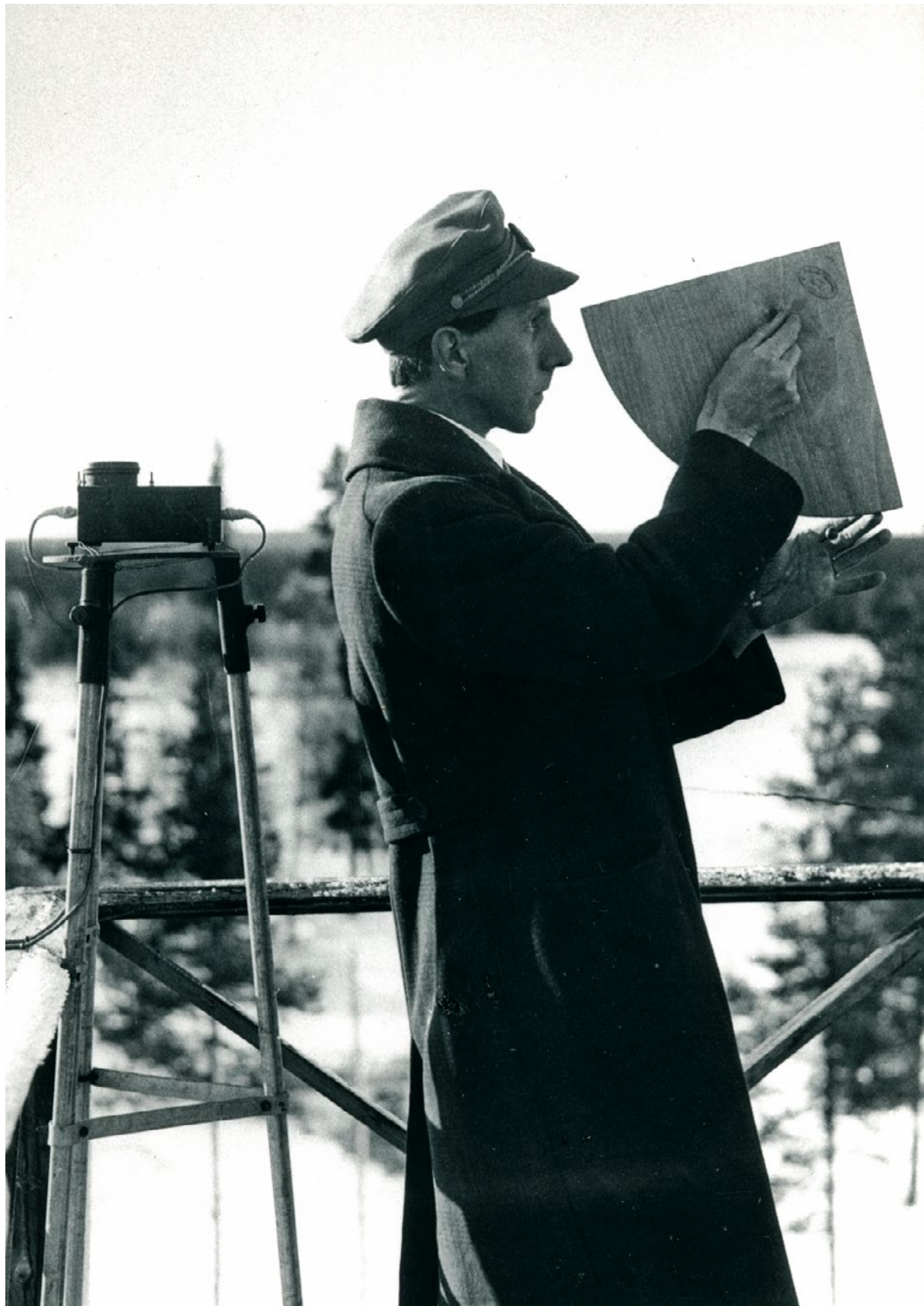
Sodankylän geofysiikan observatorion johtaja Eyvind Sucksdorff (1899–1955) tekemässä revontulien korkeusmittauksia tähtäinlaitteella.
