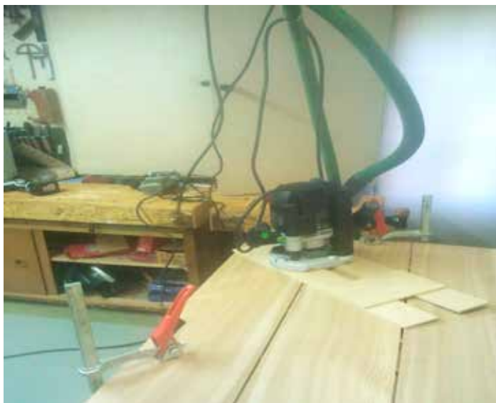
Kuva 4. Jyrsin ja jyrsimen jigi. Reiän jyrsiminen pöytälevyn alapintaan jalan liitosta varten.
