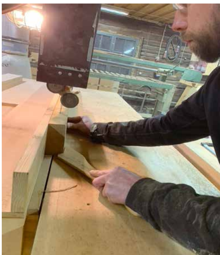
Kuva 2. Laudan halkaiseminen vannesahalla, halkaisuvastetta ja työntökapulaa apuna käyttäen
