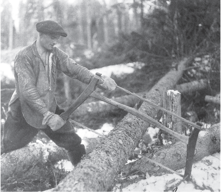
Amerikansuomalaisten siirtolaisten mukanaan tuoma pokasaha sai aikaan huomattavan tuottavuuden nousun Vienan Karjalan metsätyöpunkteilla 1930-luvulla. Kuva Karjalan tasavallan kansallisarkisto.
